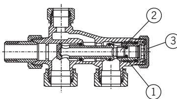
Batteriventilen levereras färdigt justerad från fabriken som ventil för 2-rörsystem.
